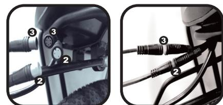
Passa o cabo (1) do motor pela parte superior do tubo localizado próximo ao selim, faça a conexão do conector (2) com o motor e prenda o cabo com abraçadeira nos suportes do quadro (3), a sobra do cabo deve ser dobrada e inserida dentro do tubo, e fixada na vareta do bagageiro com as abraçadeiras (4) como indicado abaixo:
