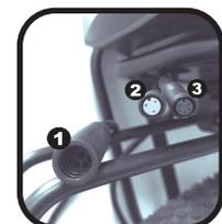
2 - Verifique que temos uma seta na lateral do conector, identifique o cabo pela cor e tipo de plug, posicione o conector de acordo com a seta e cor correspondente e ligue os cabos (2) e (3) como indicado ao lado:
