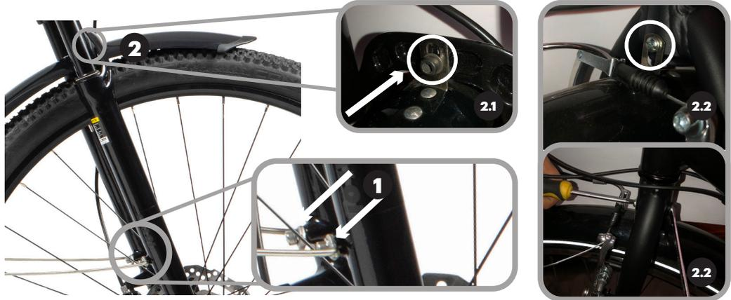
\*Ajuste o paralama de modo que este não tenha contato com o pneu.
