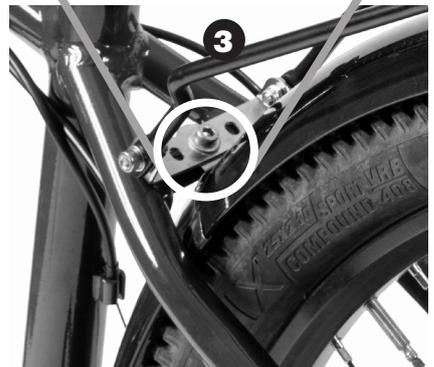
**\*TORQUE DE APERTO PARA TODOS OS PARAFUSOS 4-5Nm**
